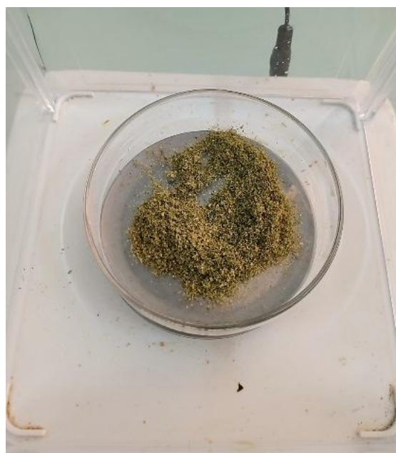
Figure 3.3 : Détermination de la masse sèche de la poudre broyée de Lemna minor (lentille d'eau) après séchage à l'étuve, en utilisant une balance analytique de précision.
