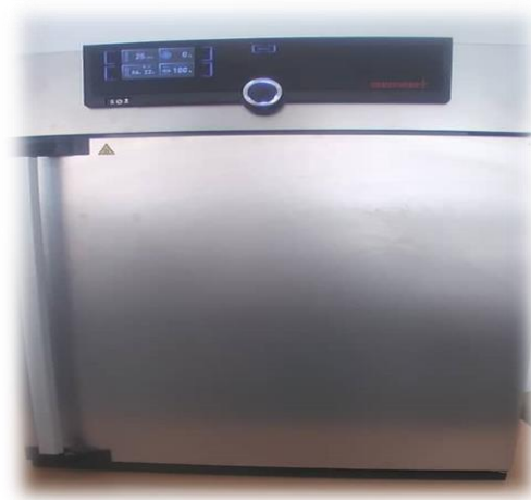
Figure 32 : Étuve de laboratoire utilisée pour l'incubation des graines dans tous les protocoles expérimentaux.
