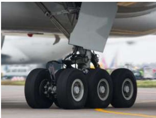
Figure II.8 : Atterrisseur principal de Boeing 777-300.
