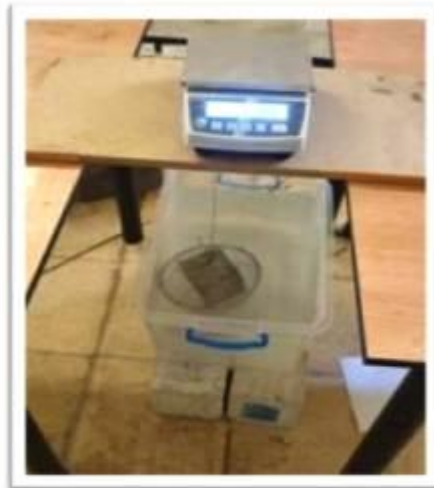
Figure 4.26: Pesée hydrostatique des BCR
