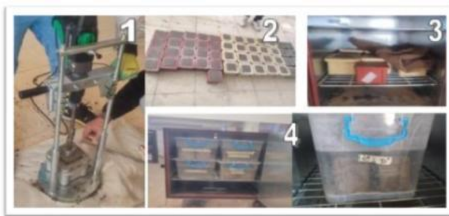
Figure4.17: Étapes de réalisations de BCR au laboratoire
