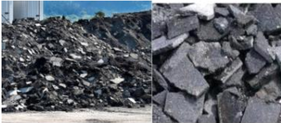
Figure 2.5 : Stockage des déchets de béton bitumineux (DBB) sur chantier .
