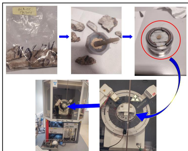
Figure 4.29 : Etapes de préparation d'échantien pour essai DRX.
