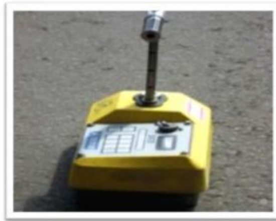
Figure 1.9 :A Jauge nucléaire pour mesurer le degré de compactage d'une chaussée en BCR.
