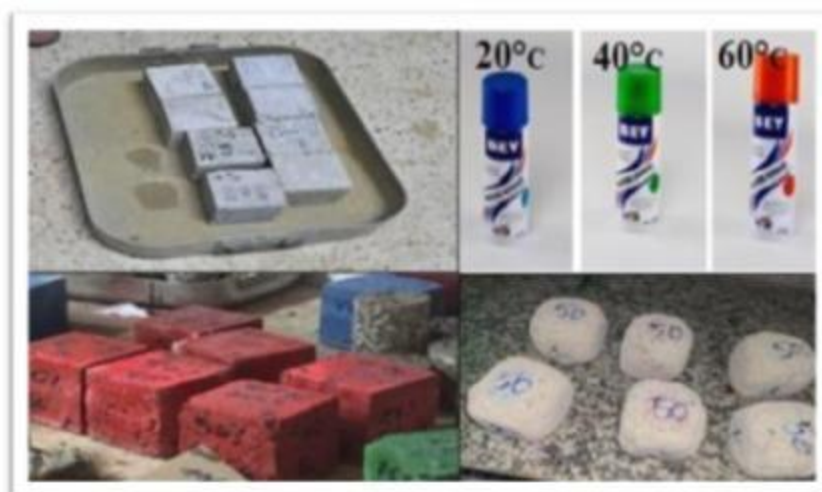
Figure 4.23 : Coloration pour différencier les éprouvettes avant l'expérience
