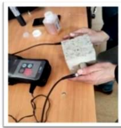
Figure 4.18 : Mesure de l'UPV des BCR.
