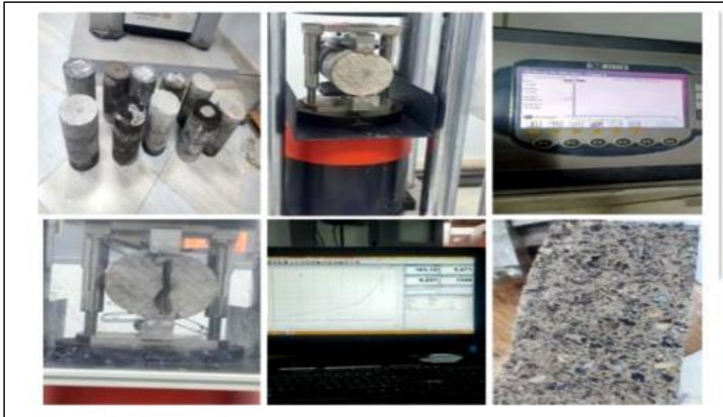
Figure 4.22 : Essais de flexion par fendage (essai Brésilien) sur cylindres de BCR (16×32 cm 2 )
