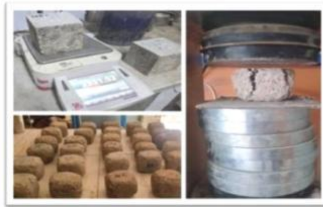
Figure 4.24 : Format des éprouvettes avant et après l'essai avec leurs écrasements.
