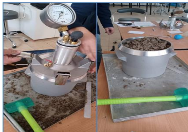
Figure 4.15 : Airomètre à pression d'air essai de l'air occlus
