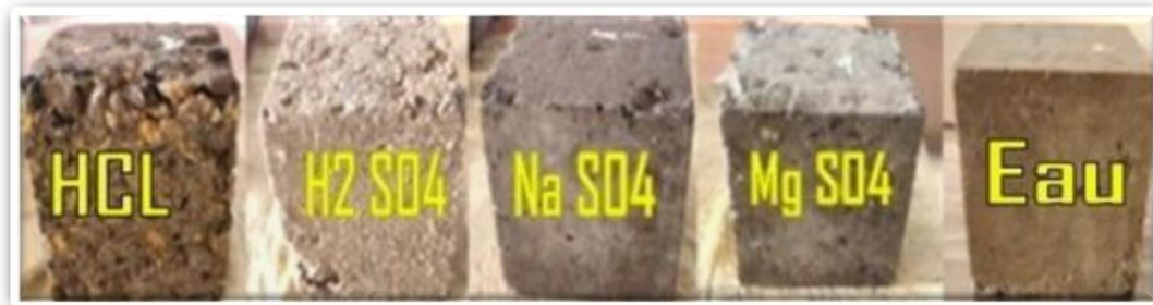
Figure 5.21 : Etats des éprouvettes dans les milieux agrissive après 28j
