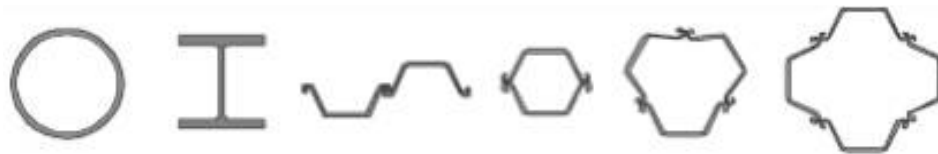
Figure (4.10) Profilés métallique battus.
