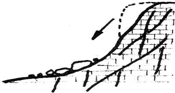
Figure (3.2) Écroulement rocheux par dislocation interne
