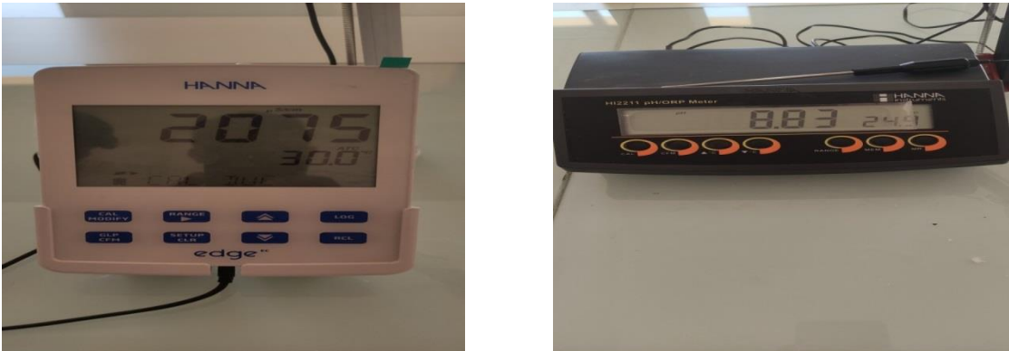
Fig.13- Mesure de Ph et CEC pour l'eau de robinet utilisée dans l'arrosage.
