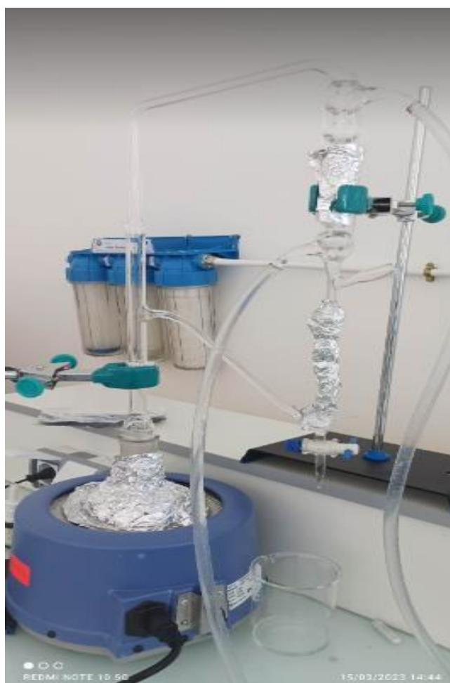
Figure 06 : L'extraction par Hydro distillation à la vapeur d'eau de type clevenger.
