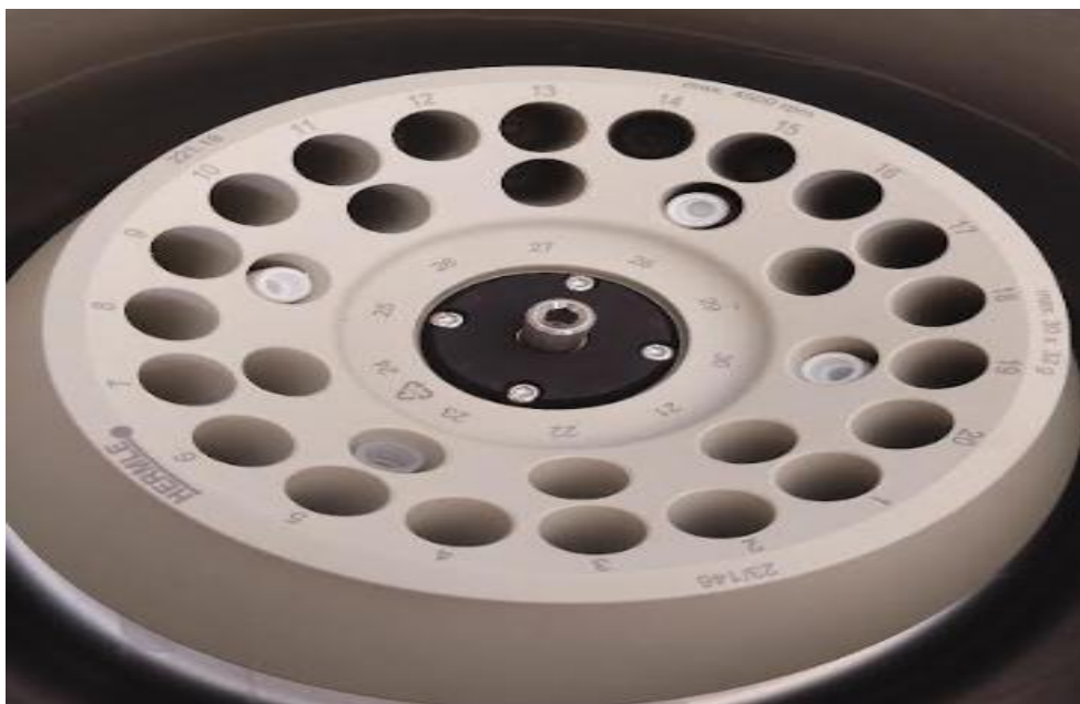
Figure 14 : L'emplacement des 4 tubes à hémolyse contenant les 4 émulsions dans la centrifugeuse.
