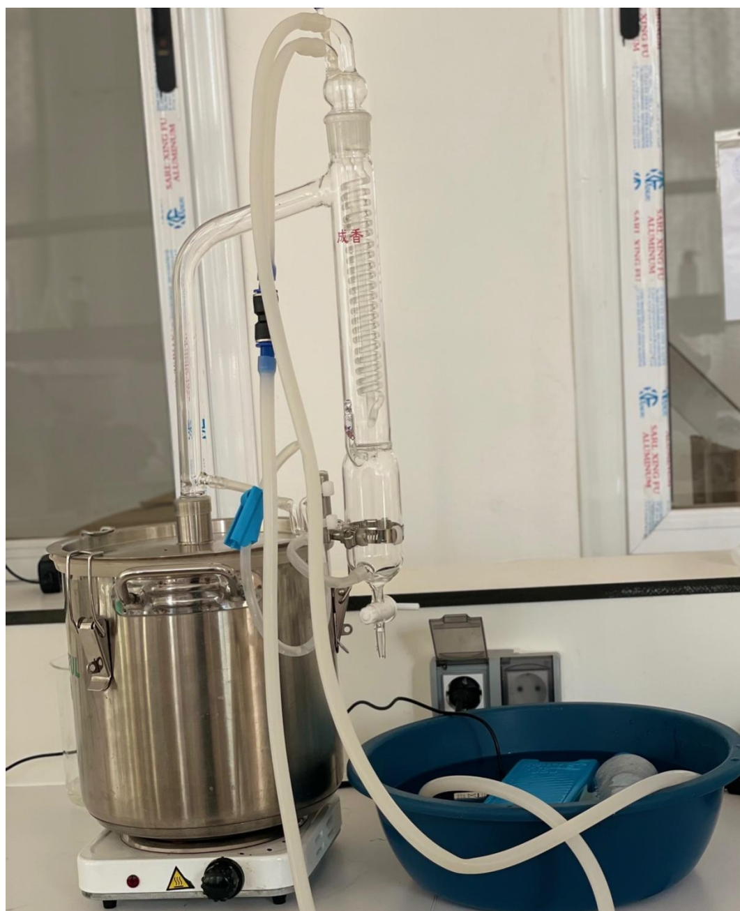
Figure 11: Extraction des HEs par hydrodistillateur de type Clevenger modifié
