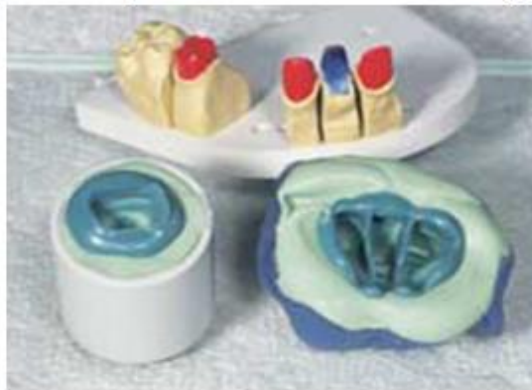
Figure I.28 : Empreintes pour la réalisation du duplicata en plâtre
