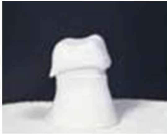
Figure I.34 : Après la première étape (120°C) le plâtre s'est rétracté et détaché de l'infrastructure prothétique en cours d'élaboration
