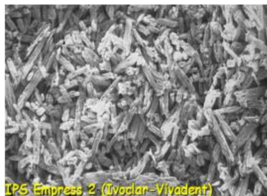
Figure I.43 : microphotographie en microscopie électronique à balayage d'un échantillon de vitrocéramique Empress 2
