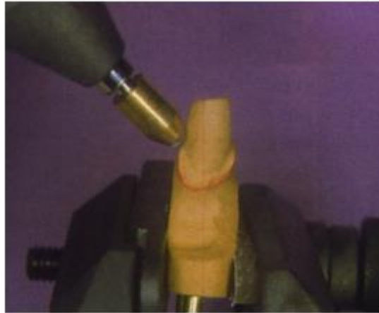
Figure I.41 : Le palpeur numérise le modèle positif unitaire (20 000 points par élément) Usinage
