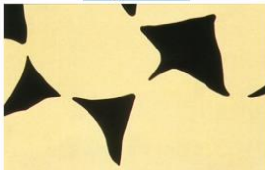
Figure I.36: Formation de « cous » de contact concaves contrastant avec la convexité des surfaces des particules
