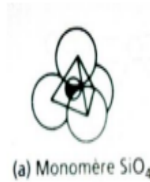
Figure I.9 : Structure de \text{SiO}_4
