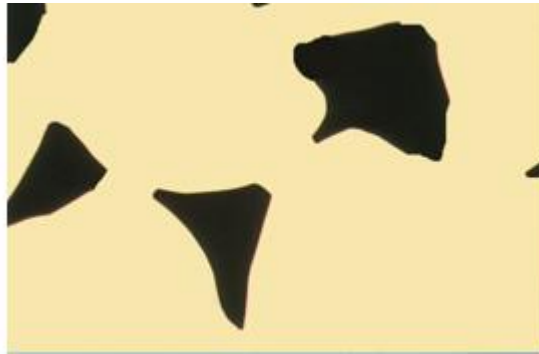
Figure 1.37 : Croissance des « cous » - Formation d'un réseau de pores interconnectés - Rapprochement du centre des particules (rétraction = 0,3%)
