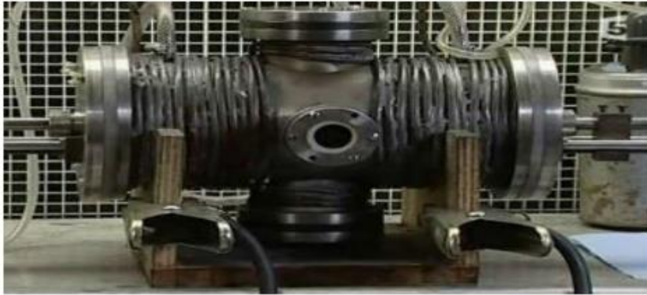
Figure . I.13 Schéma d'un réacteur de synthèse de nanotubes monocouches par arc électrique [25]
