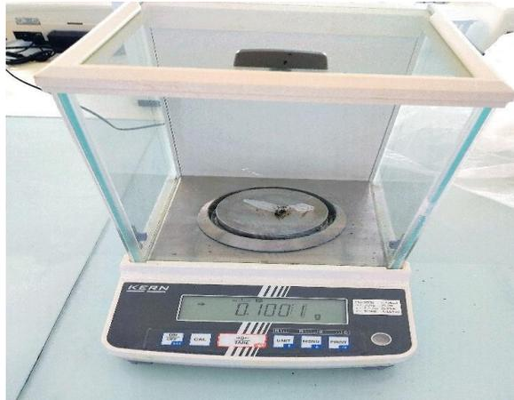
**Figure 30-** Pesée précise de 0,2g d'extrait à l'aide d'une balance de précision.
