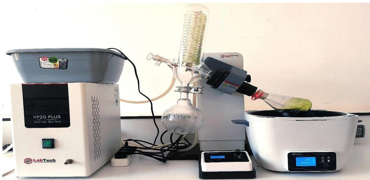
**Figure 26- Concentration des EV par évaporation sous vide à l'aide d'un évaporateur rotatif.**
