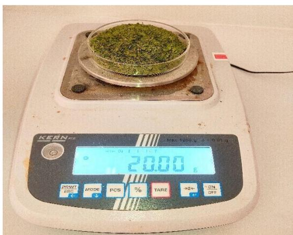
**Figure 23-** Pesée précise de 20g de plante sèche sur balance électronique pour la préparation des extraits.
