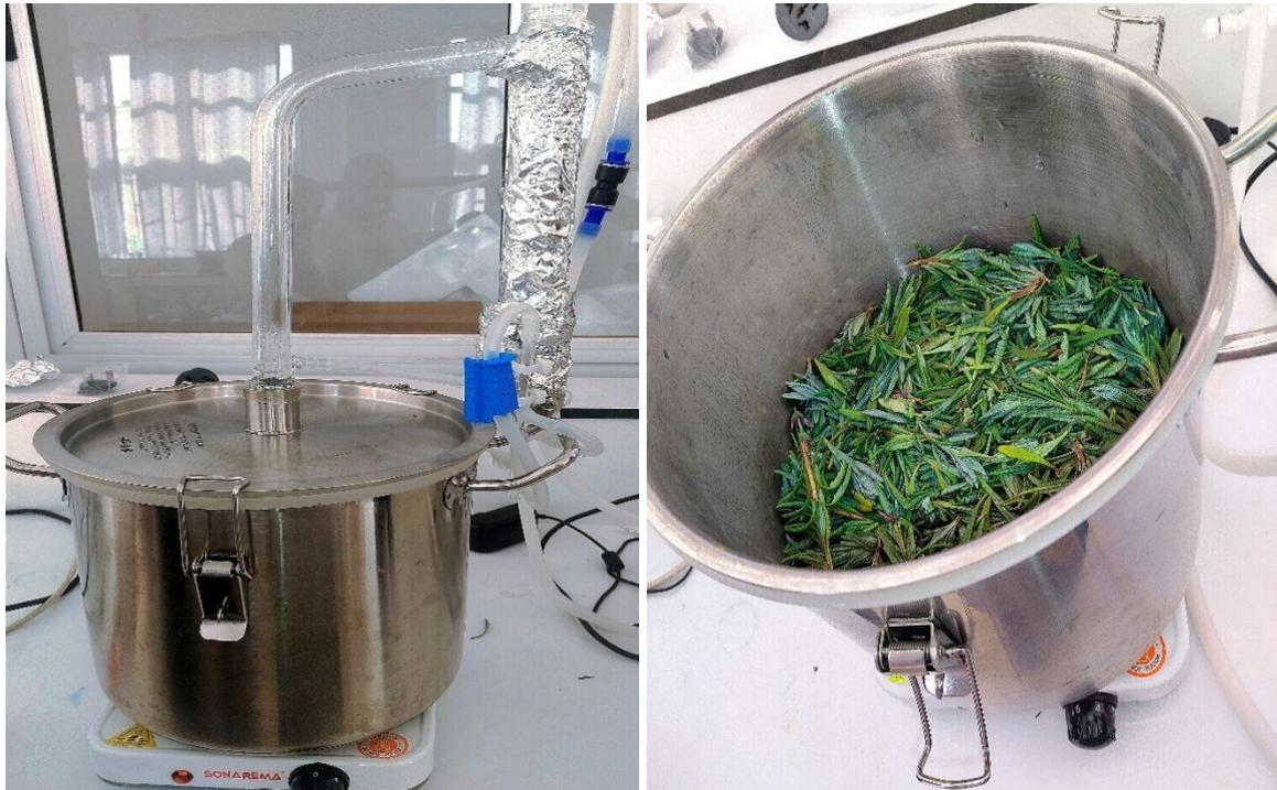
**Figure 20-**Appareil d'hydro distillation (type cleverger) utilisé pour l'extraction de l'EH.
