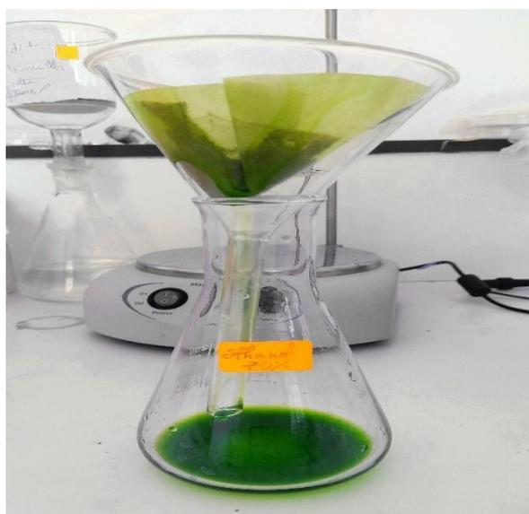
**Figure 25-** Filtration réalisée à l'aide d'un papier filtre PRAT DUMAS grade 106, diamètre 125 mm, rétention des particules : 7–10  $\mu\text{m}$ .
