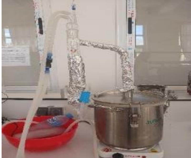
Figure 18: Appareil hydrodistillateur (**image originale**)
