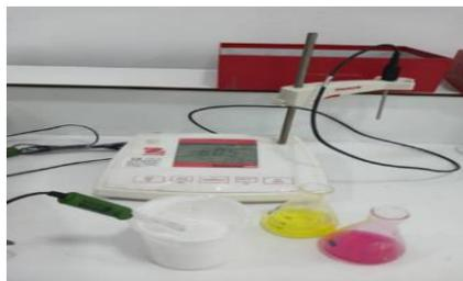
Figure 31: Test de pH d'une crème anti-moustique (image originale)
