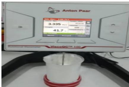
Figure 30 : Test viscosité d'une crème anti-moustique (image originale)
