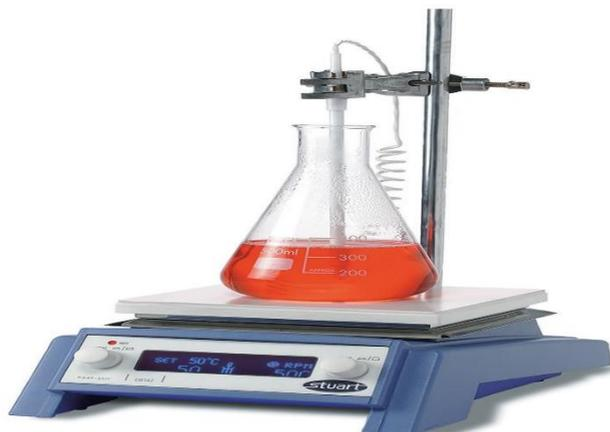
Figure 4. Gélose PCA en cours de dissolution sur agitateur magnétique chauffant
