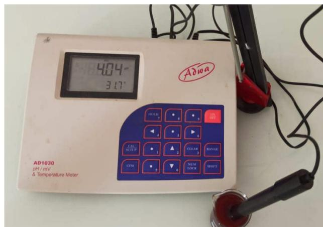
Mesure du pH du sirop à l'aide d'un pH-mètre électronique
