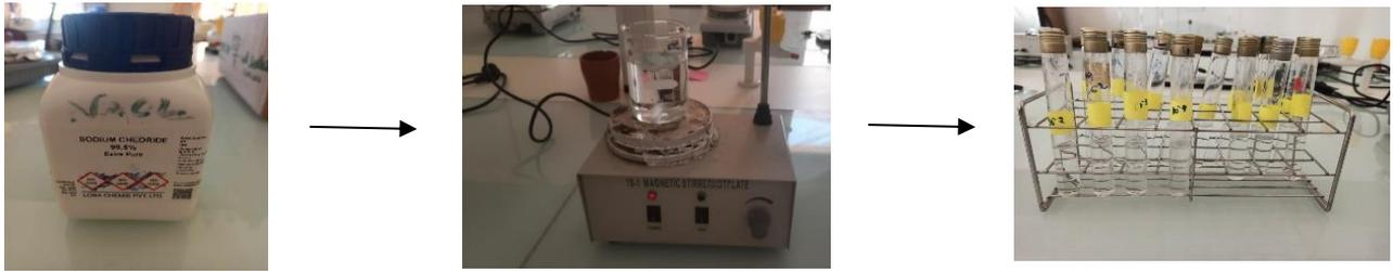
**Figure 51** : Étapes de préparation, répartition en tubes et stérilisation à l'autoclave du sérum physiologique (NaCl 0,9 %) (photo réelle)
