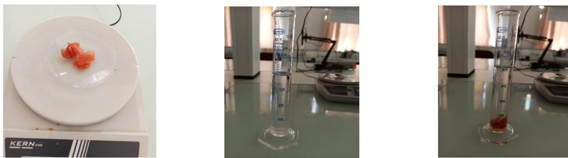
**Figure 42** : Etapes de mesure de la densité des bonbons gélifiés. (Photo réelle)
