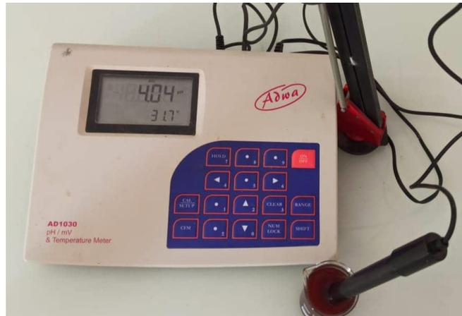
**Figure 55** : Evaluation du pH du sirop. (Photo réelle)
