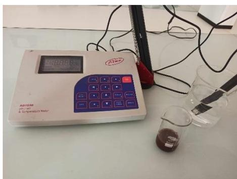
**Figure 38** : Mesure du pH avec un pH mètre. (Photo réelle)
