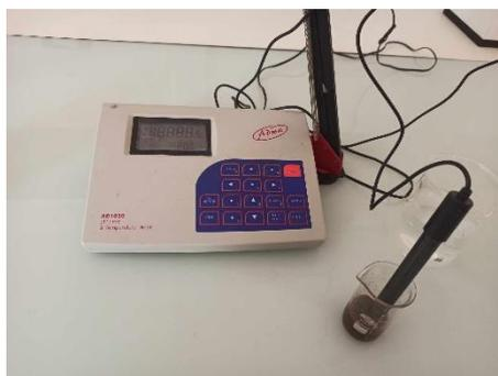
**Figure 39 :** Echantillon pour la mesure du pH. (Photo réelle)
