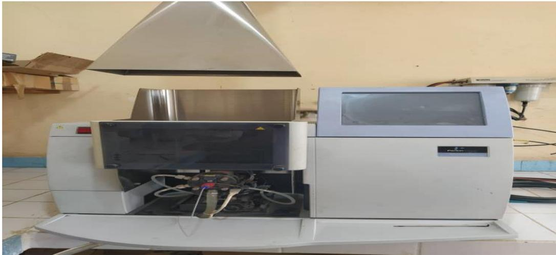
**Figure 30 :** Appareil Absorption atomique A4-7000 (Mazari H. & Ouadah A., 2025).
