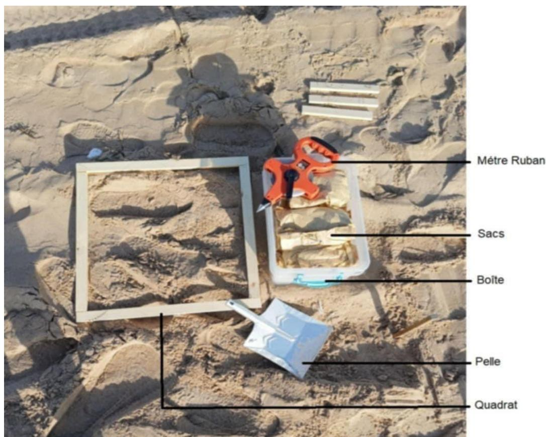
**Figure 10** : Matériel utilisé pour les prélèvements
