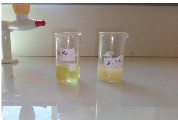
Photo 03 : Titrage de Chlorure par la méthode de Mohr
