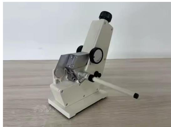
Photo 04 : Refractomètre ABBE
