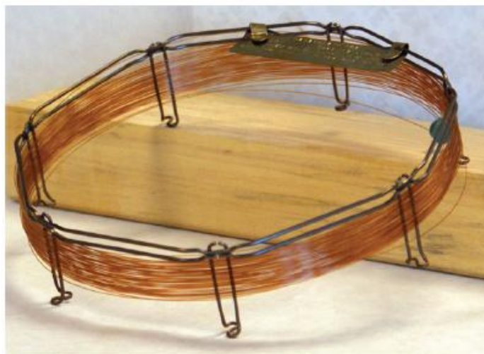
Figure I.13 : Exemple typique d'une colonne capillaire pour la chromatographie en phase gazeuse.
