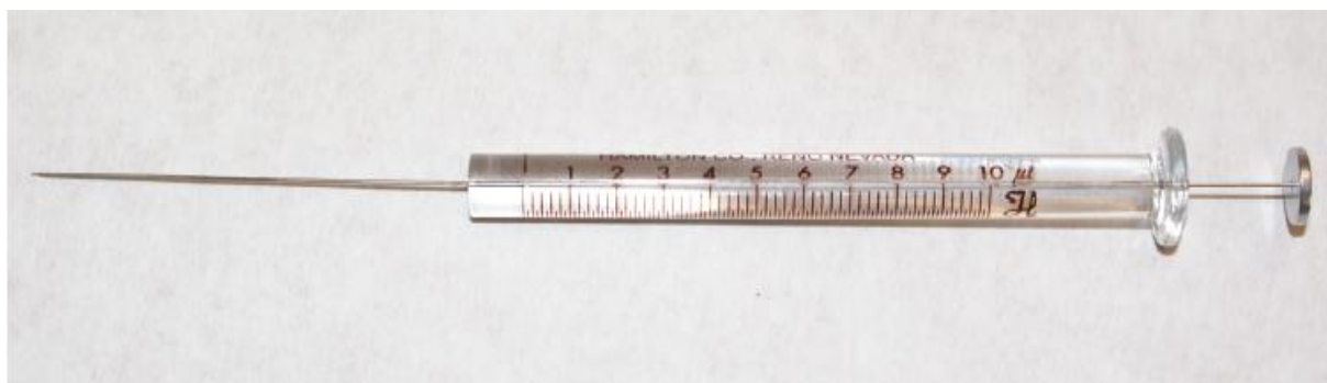
Figure I.17 : Exemple d'une seringue pour injecter des échantillons dans un chromatographe en phase gazeuse.
