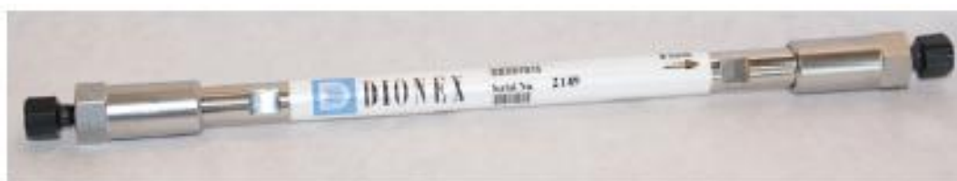
Figure I.22 : Colonne garnie typique pour HPLC
