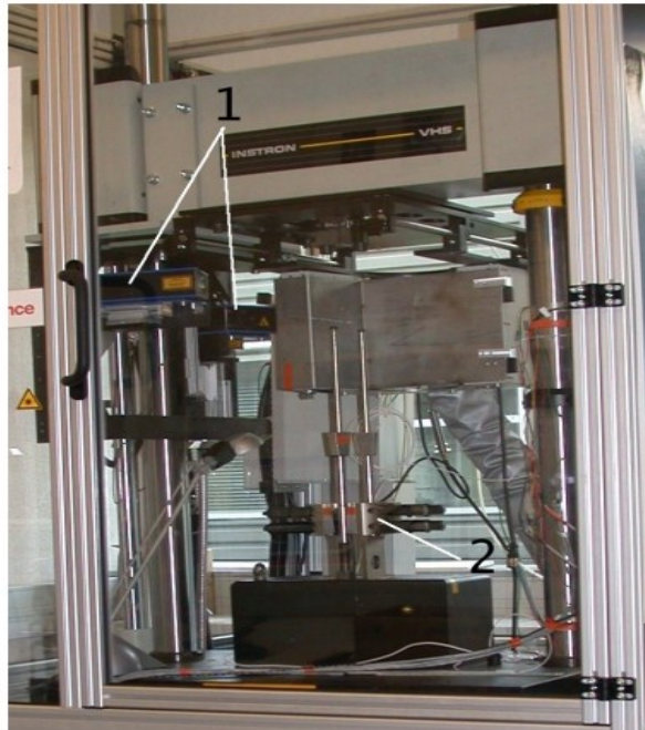
Fig. 14. Dispositif de traction grande vitesse (TGV) du CdM. 1) Cellules laser à effet Doppler pour la mesure de déformation 2) Dispositif de mors enserrant l'éprouvette "à la volée" lorsque la vitesse de déplacement désirée est atteinte. La vitesse de déplacement maximale de la traverse est de 25 m/s, la charge maximale de 80 kN, l'énergie d'environ 6 kJ ; il est possible de réaliser des essais en température, entre -135 et +250 °C. [Centre des Matériaux (CdM) de l'Ecole des Mines de Paris].
