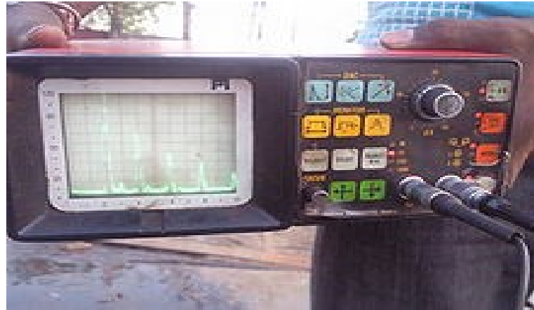
Fig. 1. Dispositif de contrôle par ultrasons [16]
