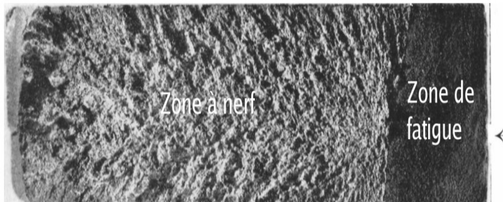
Fig. 21. Fracture d'un tirant d'assemblage de rotor d'alternateur amorcé (à droite) au niveau de la flèche par une fissure de fatigue ayant amené la rupture fragile, caractérisée par l'aspect de chevrons (à gauche) [33]
