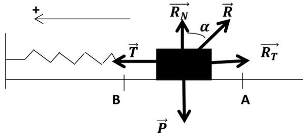
Le coefficient de frottement est :  $\mu = \text{tg}(\alpha) = \frac{R_T}{R_N}$
