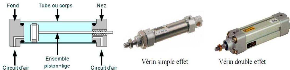
Figure I-17. Actionneurs pneumatiques (vérins)
