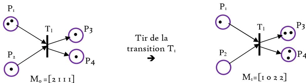
Figure II-14. Franchissement d'une transition
