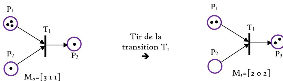
Figure II-13. Franchissement d'une transition
