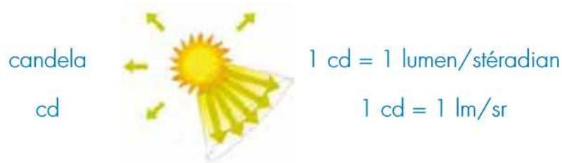
Figure IV-34. Intensité lumineuse
