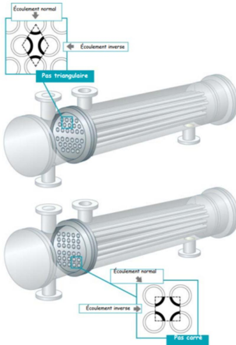
Figure 23 : Disposition des tubes du faisceau
