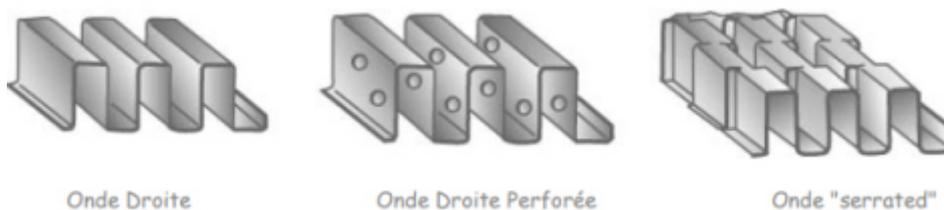
**Figure 34 : Différents types d'ondes pour les échangeurs à surface secondaire**
