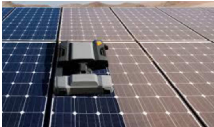
Figure II. 26 : Panneaux solaires nettoyés automatiquement [81].
