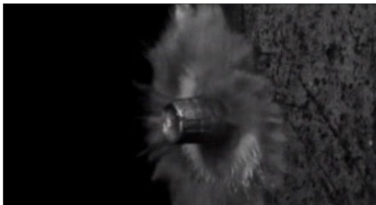
Figure VII.7 : La balle se transforme en «poussière» à l'impact avec les mousses métalliques composites évoluées
