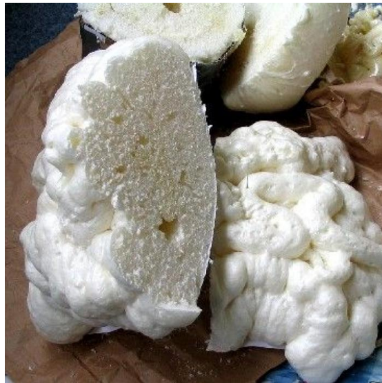
Figure VI.5 : isolation thermique par mousses polymères expansées
