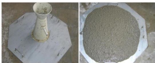
Figure 21 ; Essai d'étalement au cône d'Abrams
