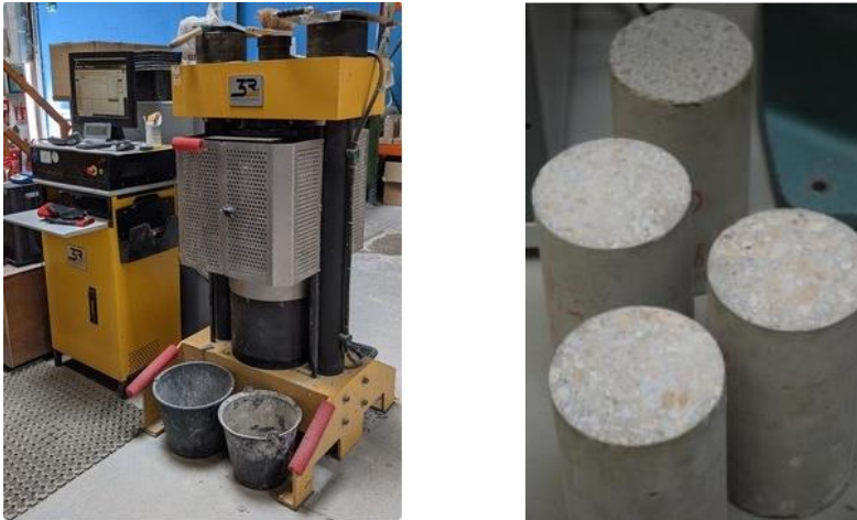
Figure 5.10: Essai de compression sur une éprouvette de béton (Norme NF EN 12390-3)
