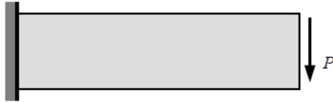
**Figure 5.2** Géométrie, support et chargement de la poutre encastree.
