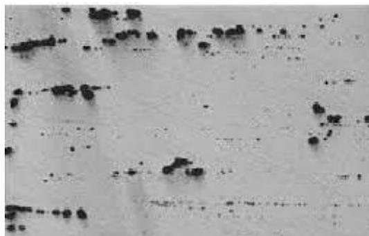
Figure I.7 : Corrosion par piqûres de l'alliage 7075 T7351, après 2 h d'immersion dans une solution de  $\text{Na}_2\text{SO}_4 + \text{NaCl}$  [2]
