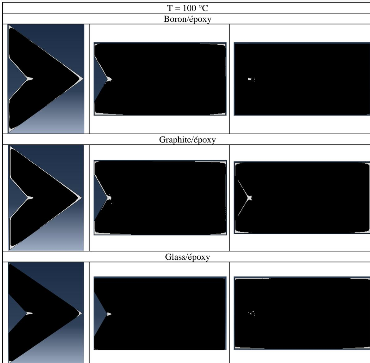
Figure III.14 : Zone endommagée dans l'adhésive pour fissure de taille  $a = 5\text{ mm}$
