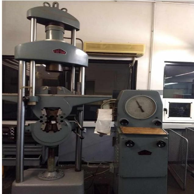
Figure V7. L'appareille de traction (Usine ORSIM)
