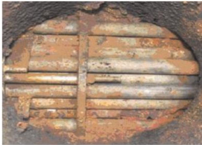
Figure I.9. L'encrassement par corrosion [24]
