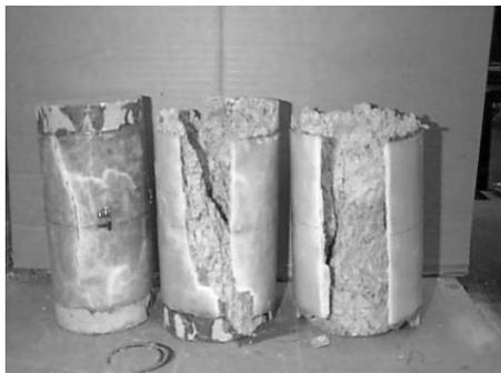
**Figure.7.13** : Modes de rupture d'un béton renforcé par un FRP à base de fibres de verre et de résine époxy soumis à une charge de compression [20].
