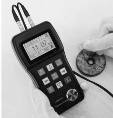
**FIG.44** Contrôle non destructif par Ultrason
