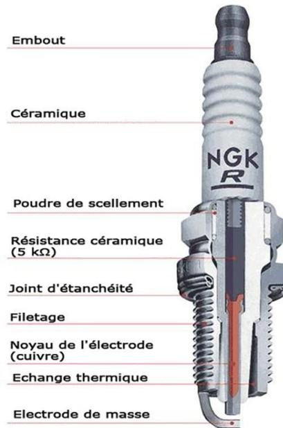
FIG.7 Schéma détaillé d'une bougie d'allumage
