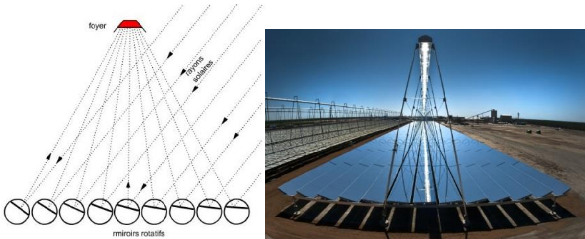
Figure (2.33) : Concentrateur linéaire de Fresnel (AREVA Solar)
