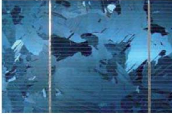
Figure (2.22) : Des cellules de silicium polycristallin.
