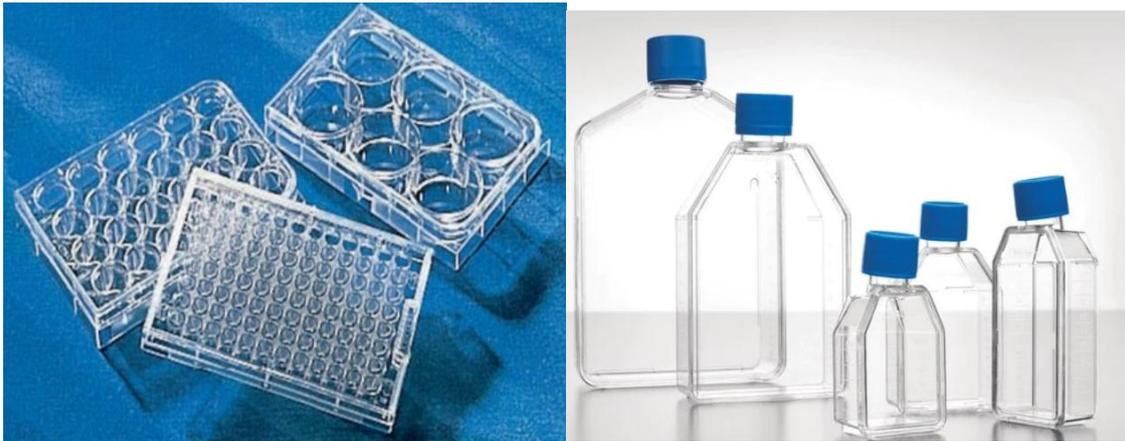
**Figure 7 :** A gauche : Plaque à puits multiples (6 puits). A droite: Flacon de culture.
