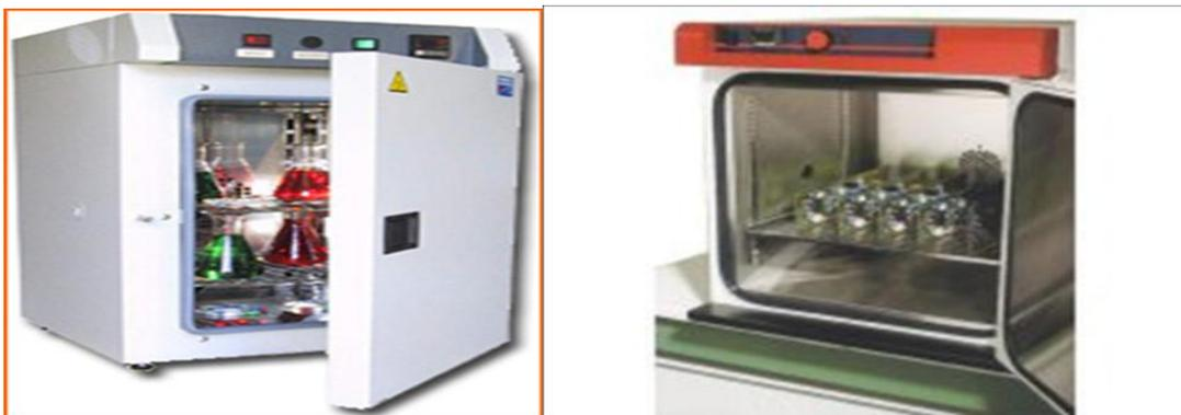
**Figure 9 :** L'étuve de POUPINEL (le four de Pasteur).
