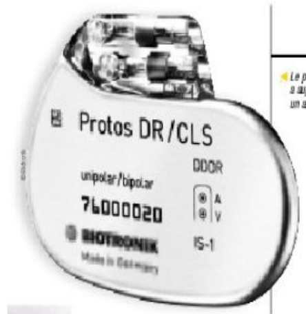
Pacemaker avec accéléromètre intégré
